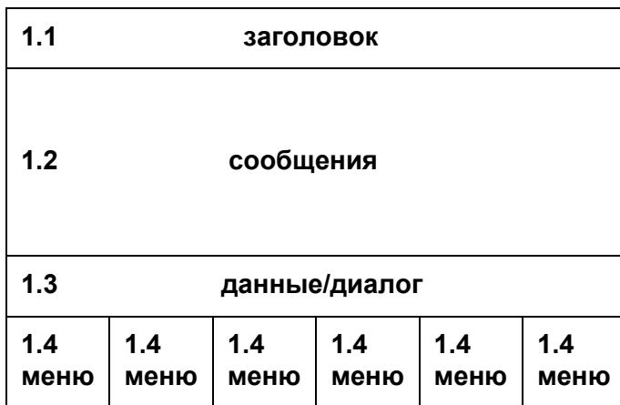
Рис. 3.2: Зоны индикации ЖК-дисплея
